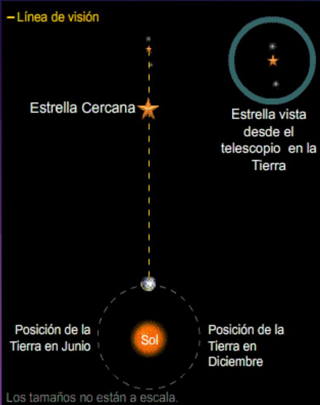
En este método se utiliza el fenómeno de la paralaje en dos observaciones separadas seis meses de un objeto relativamente cercano enfrentado al fondo “fijo” del cielo. Se resuelve el triángulo rectángulo de la figura, donde se conoce el ángulo de paralaje (mitad del desplazamiento medido entre las dos observaciones separadas 6 meses) y la distancia Tierra-Sol (150 millones de kilómetros) por trigonometría simple se resuelve la cantidad  $D$ , distancia que nos separa del objeto.
