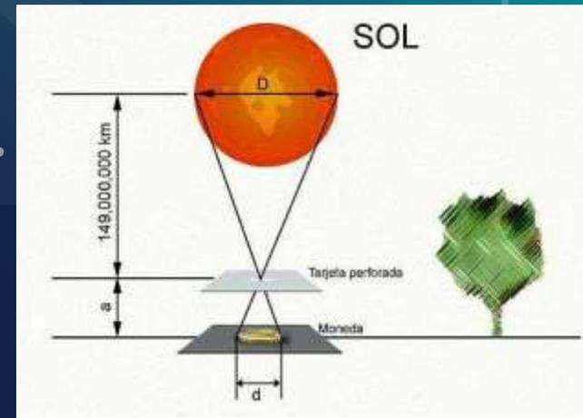
En la figura aparecen **dos triángulos**. Ambos tienen un vértice en el agujero de la tarjeta, pero la base de uno es el diámetro del sol,  $D$ , y la base del otro, el diámetro de la moneda,  $d$ . La altura del primero es la distancia al sol (149,000,000 kilómetros) y la del segundo es simplemente la distancia entre la tarjeta y la moneda. Como son **triángulos semejantes**, podemos escribir:
