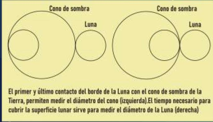
El primer y último contacto del borde de la Luna con el cono de sombra de la Tierra, permiten medir el diámetro del cono (izquierda). El tiempo necesario para cubrir la superficie lunar sirve para medir el diámetro de la Luna (derecha)
