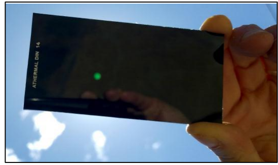
Figura 13. Los “vidrios” o filtros de soldador están fabricados en vidrio, con un tamaño de unos 100 x 50 mm y 2 a 3 mm de espesor. En uno de sus bordes se indica el nivel de absorción expresada por un número de las normas alemanas DIN. El adecuado para observar el Sol es el N°14.
