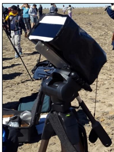
Figura 25. Izquierda, cámaras equipadas con filtros, los cuales se pueden adquirir en comercios especializados. Derecha, cámara equipada con un filtro de soldador, se cubrió el conjunto con un grueso plástico negro para evitar reflejos y facilitar la visión de la pantalla de la máquina. Las dos imágenes fueron obtenidas en oportunidad del eclipse anular de Sol del 26 de febrero de 2017 en la localidad de Facundo, Chubut.
