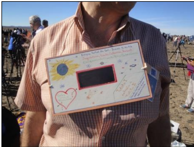
Figura 14. Izquierda, un filtro de soldadura DIN 14 montado en un cartón, como expresan las inscripciones, fue utilizado exitosamente en el eclipse de 1994. Derecha, un filtro de soldadura fue cortado en dos partes y montado sobre cartón mediante cintas adhesivas para formar un antejo. Las fotografías se obtuvieron en oportunidad del eclipse anular de Sol de 2017 observado desde la localidad de Facundo, Chubut (S. Paolantonio y M. Orellana).
