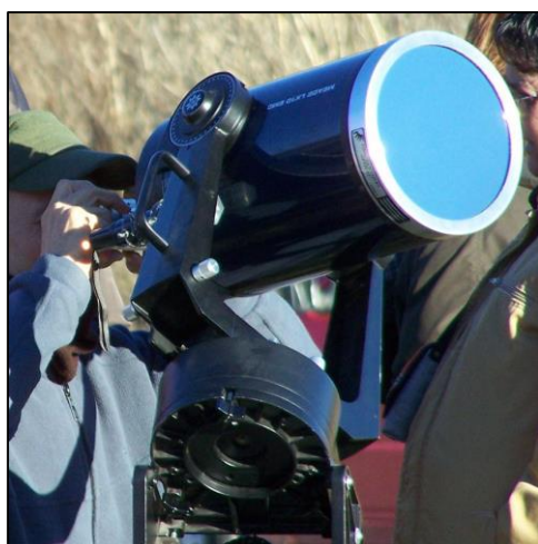
Figura 17. Filtro solar de mylar ubicado delante del objetivo de un telescopio reflector, y la imagen del Sol que producen (Plaza del Cielo).
